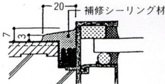
施工……タイルの目地部に浸透した油分の除去ができないため図のように盛上げる方法で施工した。
