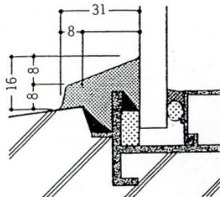
施工……(1) 既存シーリング材を全て除去することが困難なため図のように斜めに除去し盛上げて施工した。
