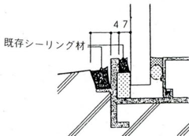
故障の原因……(1) ガラス面…既存シーリング材接着層の紫外線劣化。
