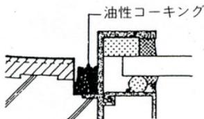
故障の原因……油性コーキングの硬化(劣化)によるひび割れ。
